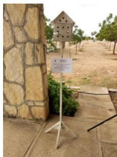
Figura 3: Abrigo meteorológico construído de madeira
