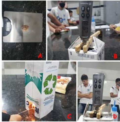
Figura 3 - Demonstração de pesagem das amêndoas (A), posicionamento do tubo de ensaio com termômetro na caixa (B) e alocação do alimento em chama no furo “b” da caixa (C). Verificação da temperatura final da água após queima da amêndoa (D) (exemplo do Grupo 3).
