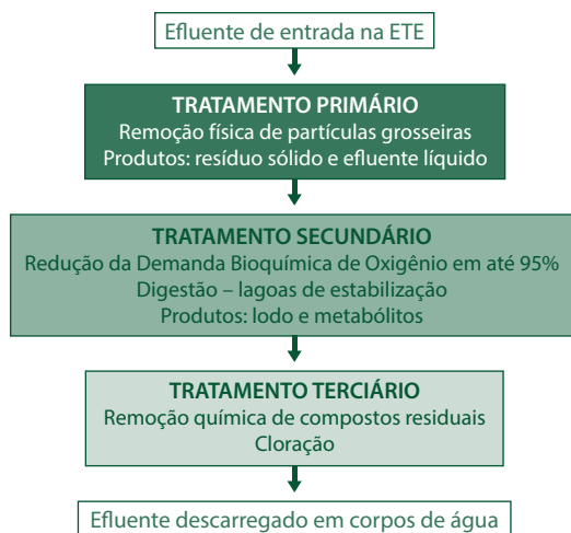
Figura 1. Sistemas de tratamento de efluentes de uma Estação de Tratamento de Esgoto (ETE).
